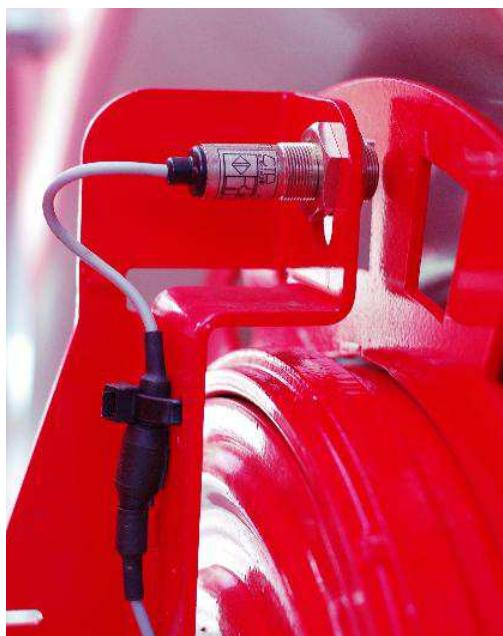
Merjenje hitrosti je izvedeno preko induktivnega brezkontaktnega senzorja. Pri voženih škropilnicah je senzor montiran na osovino zadnjega desnega kolesa (sl. 120), pri nošenih škropilnicah pa se montira na ohišje traktorja, tako da meri prehode kolesnih vijakov. Pri AG-troniku M1 je tip brezkontaktnega senzorja NPN koda: 917006-05.
