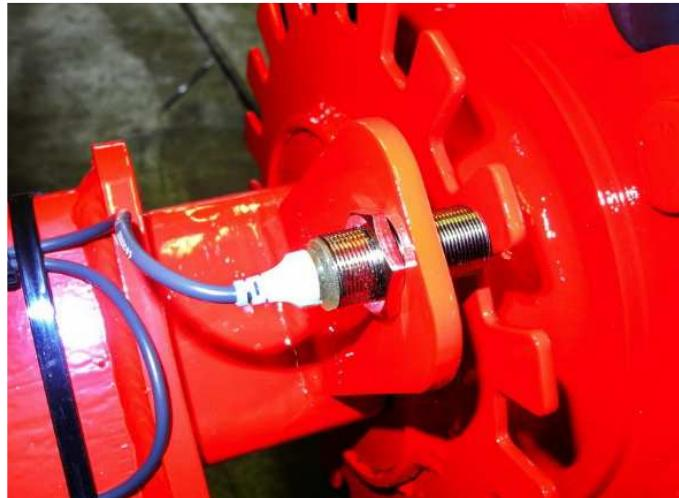
Kontrolna lučka zasveti, ko je senzor oddaljen od kovine manj kot 5mm
