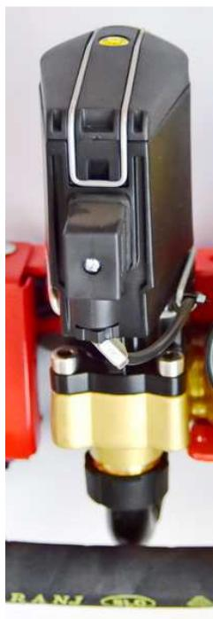
S pomočjo elektromotornega ventila reguliramo tlak škropljenja na pršilniku. Krmiljenje regulacijskega ventila poteka v AVTO režimu izključno s pomočjo AG-TRONIKA odnosno tipk, ki so montirane na Ag-troniku (poglavje 2 OPIS AG-tronika).
